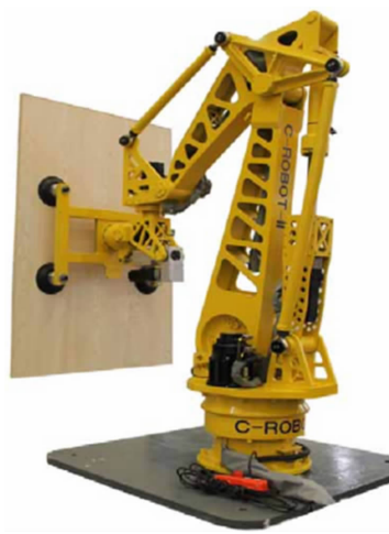
图 1 幕墙安装机器人
